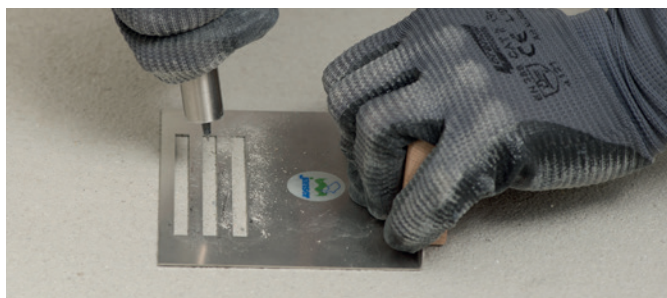
Ritzprobe per Ri-Ri-Gerät und Schablone
